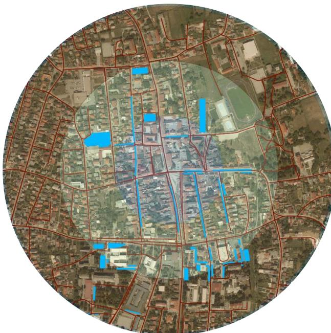
površina iznad 100% kapaciteta tijekom pojedinih vremenskih perioda posljedica je velikog broja nepropisno parkiranih vozila na legalnim površinama, što uz 10 identificiranih uličnih površina s ilegalnom parkirališnom potražnjom te identificiranih 113 nepropisno parkiranih vozila u gradskom središtu tijekom vršnog sata (legalne i ilegalne površine), potvrđuje hipotezu o potrebi učinkovitijeg upravljanja parkirališnom ponudom i potražnjom.
