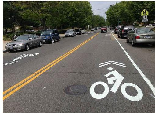
Primjer vođenja biciklista zajedničkom površinom zajedno s motornim vozilima
